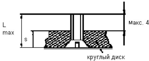
Перед свинчиванием преобразователя с измерительной вставкой проверьте длину винта. Вставьте винт в круглый диск, при этом длина выступающей части винта должна составлять 4 м.
