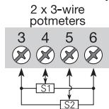
Соединения с двумя датчиками
