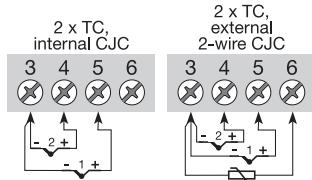
Соединения с двумя датчиками могут конфигурироваться для 2 измерения, разности, с усреднением или с резервированием
