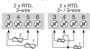
Соединения с двумя датчиками могут конфигурироваться для 2 измерения, разности, с усреднением или с резервированием
