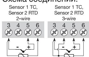
Соединения с двумя датчиками могут конфигурироваться для 2 измерения, разности, с усреднением или с резервированием
