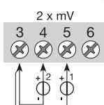
Соединения с двумя датчиками могут конфигурироваться для 2 измерения, разности, с усреднением или с резервированием
