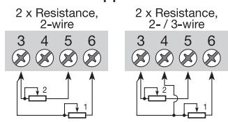
Соединения с двумя датчиками
