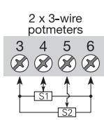
Соединения с двумя датчиками могут конфигурироваться для 2 измерения, разности, с усреднением или с резервированием
