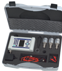
版本1：最多带5个压力传感器的校验箱
