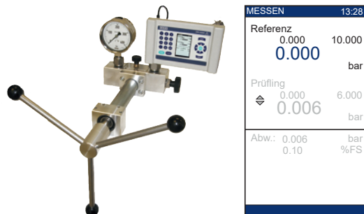
示例：CPH6000，带牢固安装的参考压力传感器、手动增压泵和客户特定测试项
